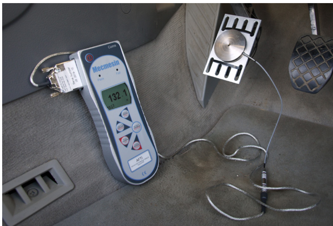
Capteur pédale accélérateur montré en cours d'utilisation
