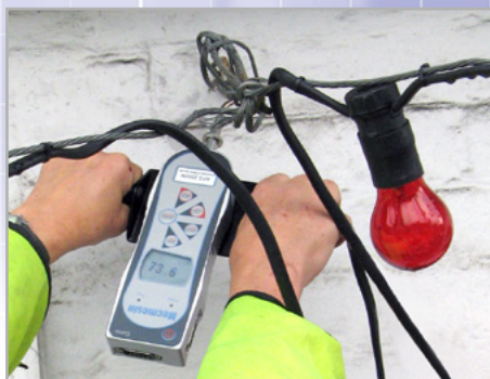
Essai de traction sur points d'ancrage
